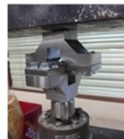
JIS Z3138に準拠した引張試験、および疲労試験
